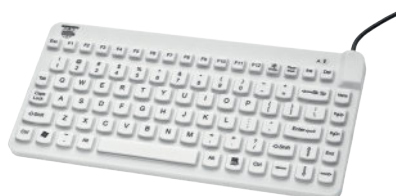
300-001-615 Клавиатура, влагозащита IP68 только латиница, кабель 1.8 м, 305x140x15 мм, 600 г.
